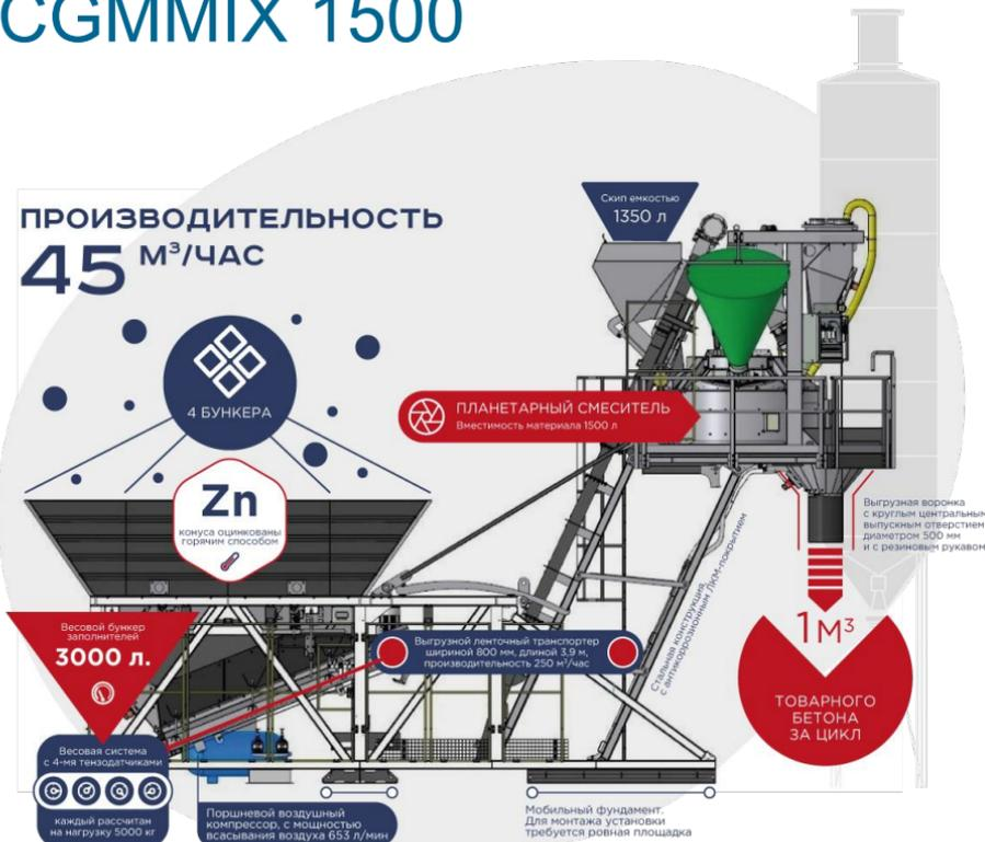
Завод спроектирован для производства до 40-45 м<sup>3</sup>/ч. стандартного товарного бетона с объемом замеса 1.0 м<sup>3</sup> за 1 цикл при непрерывном производстве. Итоговая производительность может зависеть от ограниченных возможностей автобетоносмесителей по приёму смеси.
