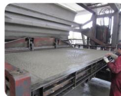
Уплотнение смеси в насадке за счет вибрации
