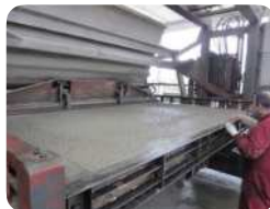
Уплотнение смеси в насадке за счет вибрации
