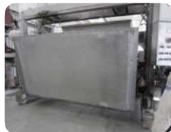
Переворот и распалубка готового изделия на пол
